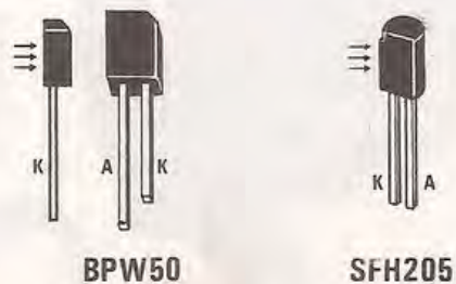
Fig. 4 Il lato sensibile del fototransistor BPW50 è quello visto frontalmente tenendo il terminale K (più corto) sulla sinistra. Nel caso dell'SFH.205 è la parte piatta del corpo (in questo caso il catodo si trova a sinistra).
