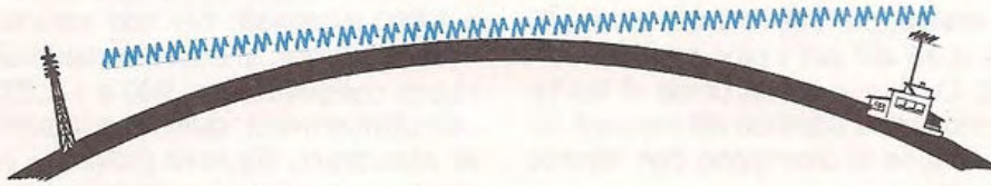
Fig. 4 La ricezione di un segnale TV in via teorica dovrebbe risultare limitata all'orizzonte ottico, quindi, considerando la rotondità della terra, se l'antenna trasmittente non venisse collocata ad una elevata altezza non si riuscirebbe mai a superare una distanza considerevole.
