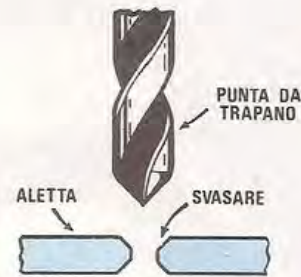
Fig. 19 Se notate che il foro presente sull'aletta risulta bordato, dovrete svasarlo con una punta da trapano.
